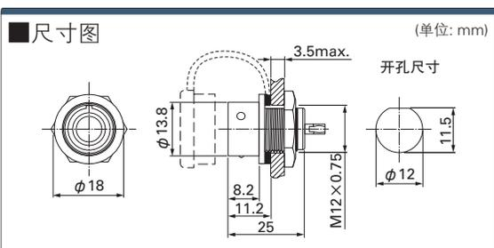
**面板安装型插座(法兰型)**
