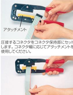
圧接するコネクタをコネクタ保持部にセットします。コネクタ幅に応じてアタッチメントを使用してください。
