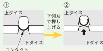
①②当圧着工具は、コンタクトのセット位置が固定となっております。コンタクトセットには、ダイスの位置関係を確認して圧着することをお勧めします。
