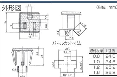
**ココが特長** パネル組込スナッピンタイプの接地2Pアウトレット
