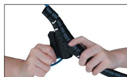
将电线穿入插入工具的圆筒部分(圆筒部分可以打开)。
